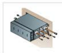
Esempio di installazione di Branch Box a 3 vie: posizioni di montaggio ammesse
