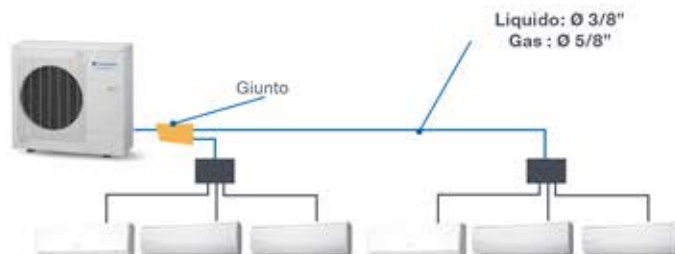
Esempio di installazione di Branch Box a 3 vie: posizioni di montaggio ammesse
