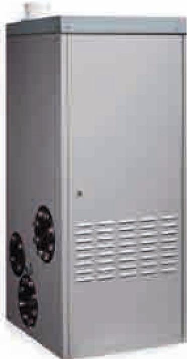
Caldaia a condensazione a basamento per centrale termica a modulazione continua ad alto rendimento Cl. 4 Stelle a basse emissioni di NOx classe 5. Generatore di calore per solo riscaldamento, è omologato per l'installazione all'interno e all'esterno (protezione IP X5D) ed è omologato dall'INAIL per l'installazione in batteria con unico tronchetto. L'allestimento comprende il circolatore modulante ad alta efficienza.
